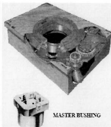
Mesa Rotativa à esquerda e à direita mesa com respectiva bucha do Kelly. FONTE: < http://www.ectool.com/product.php?pid=49 >, em nov. 2007.
