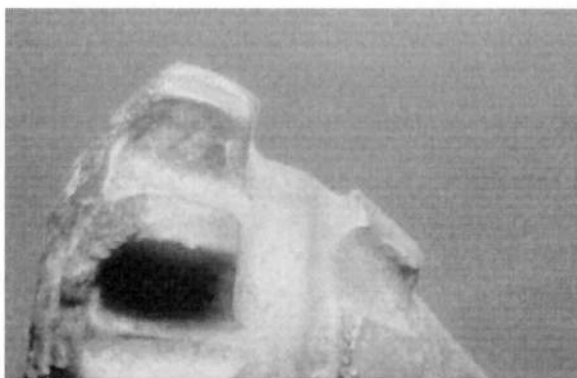
Figura 22. Dente de aço desgastado. FONTE: Manual Sperry Sun
